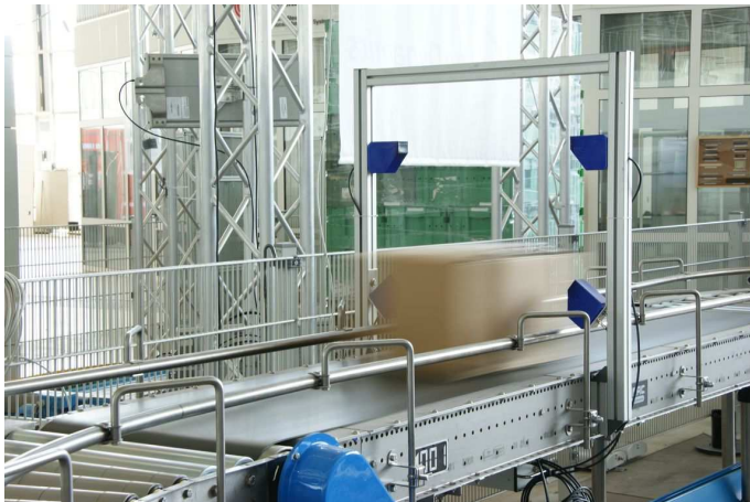
Bild 2: Scannerdusche auf der Fördertechnikanlage mit Sortierfunktion vor dem neuen AKL beim Bremer Institut für Produktion und Logistik (BIBA)
