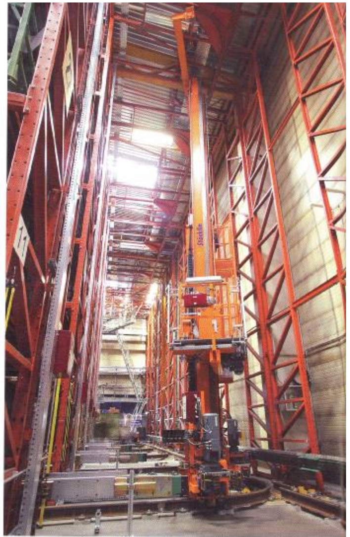
Bild 2 Regalbediengerät versetzt im Wechselgang.
