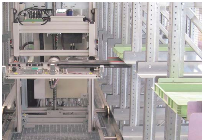
Quickstore HDS – Lastabgabe vom Shuttle in das Regal
