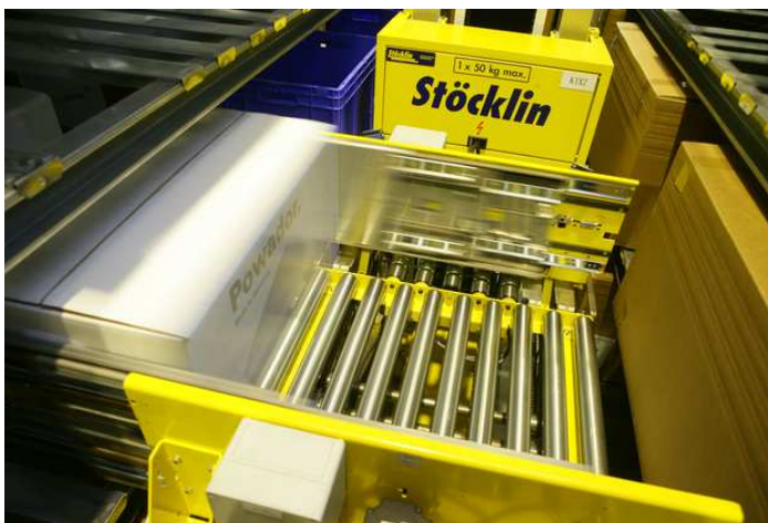
Bild 3: Kartonabgabe des Regalbediengeräts
